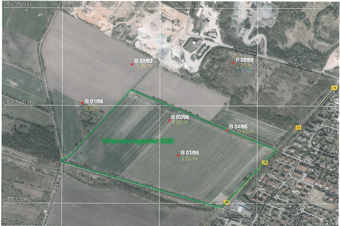
Bild 3: Übersichtskarte WIEPENKATHEN – Süd 1 : 5.000 mit Lage der Bohrungen, Nutzmächtigkeit und den Bohrprofilen
