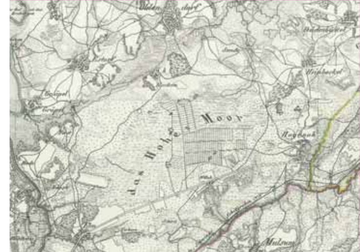
Auf der Karte von 1835 ist die systematische Anlage der Entwässerungsgräben in der östlichen Hälfte des Moores zu sehen, die für die Torfgewinnung Voraussetzung war.
