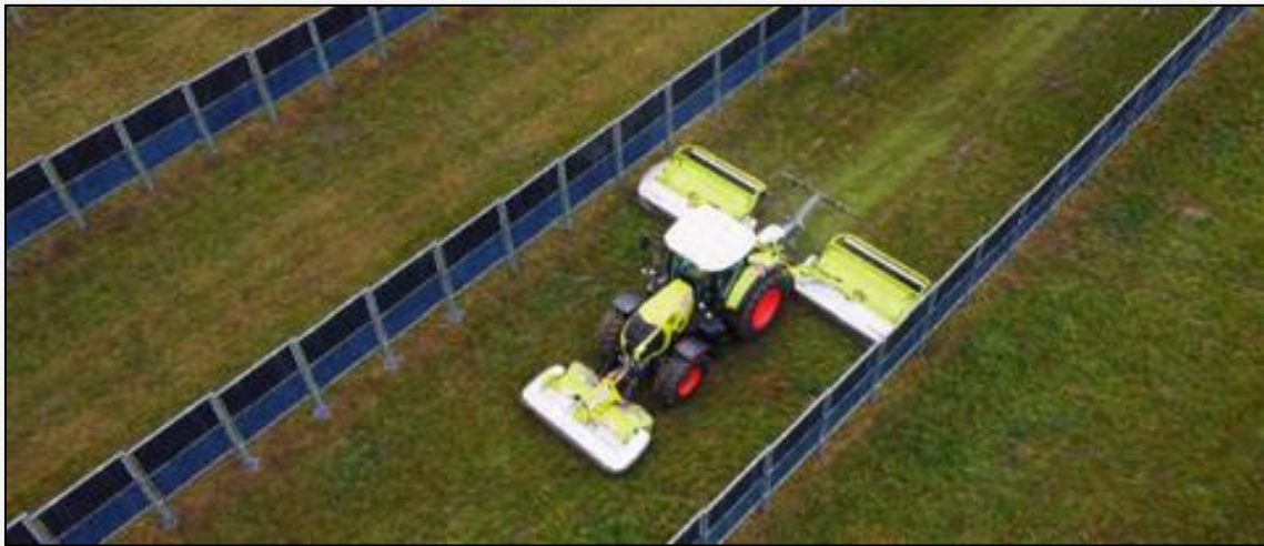
Abbildung 23: Bodennahe Agri-PV-Anlage mit "bifacial" Modulen, welche eine Bewirtschaftung zwischen den Modulreihen erlaubt (Frauenhofer ISE, 2022)
